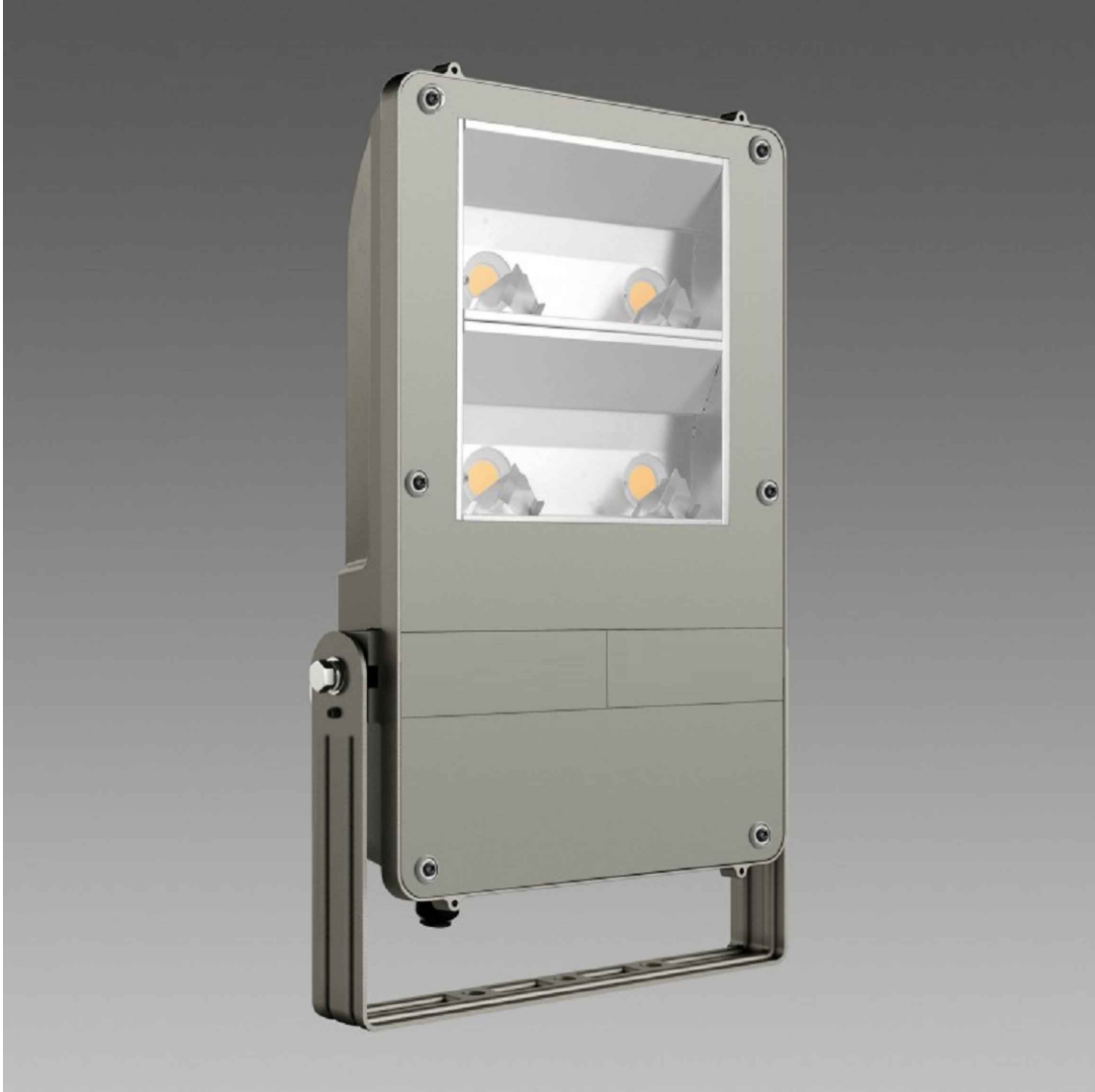
Immagine indicativa della lampada Corpo in alluminio pressofuso con alette di raffreddamento integrate nella copertura Optica in alluminio 99.95 con trattamento di PVD, finitura satinata Diffusore in vetro temperato spessore 5 mm, resistente a urti e shock termici Potenza lampada 246 W (campo da calcio), 318 W (campo da tennis)
